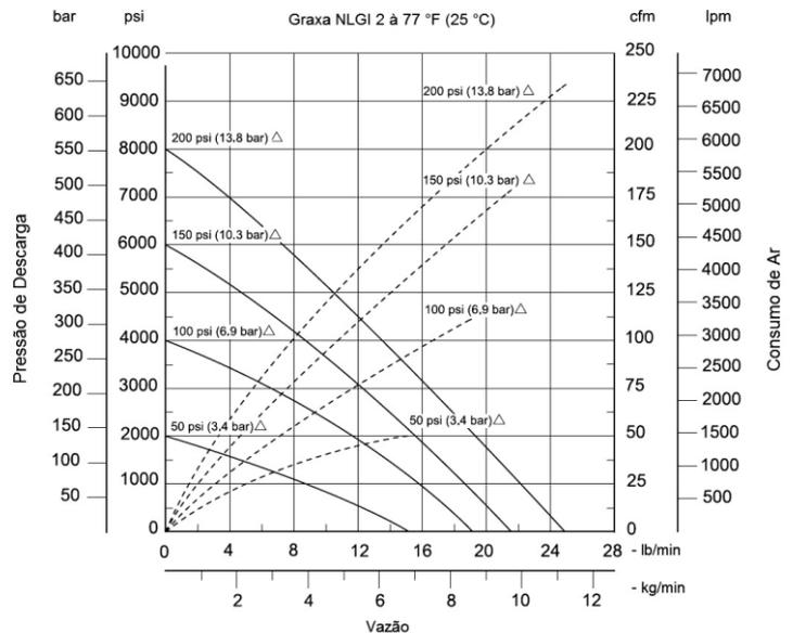
**OBS.:** Utilizar linha pneumática no diâmetro compatível com o volume de ar necessário para obter a vazão desejada.
