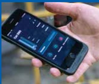
O Controlador GLC X é compatível com Bluetooth. Assim, as equipes de manutenção e os operadores podem monitorar uma ampla gama de métricas de lubrificação, incluindo níveis, pressão, configurações e muito mais.
